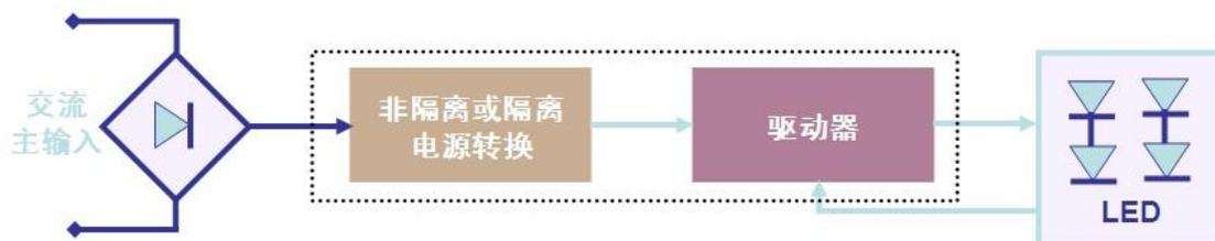
图 2: LED 驱动器的基本工作电路示意图。
