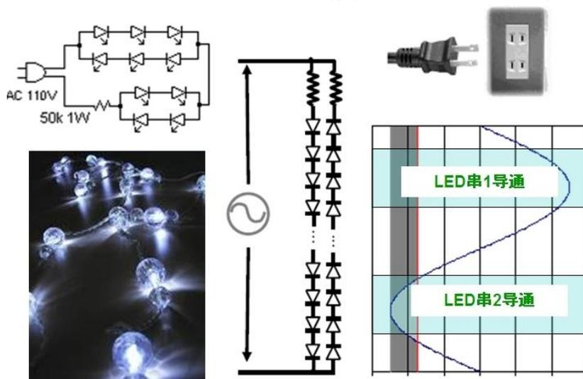
图 5: 直接采用交流驱动 LED 的示意图。
