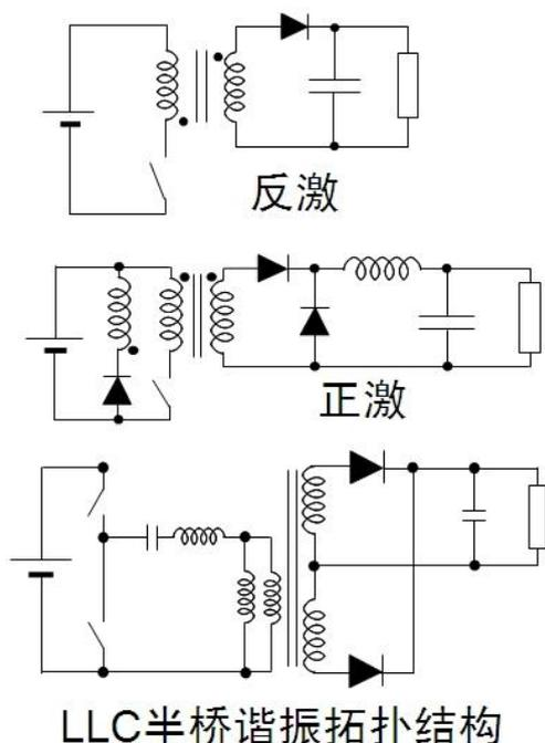
图 3: 常见的隔离型拓扑结构。
