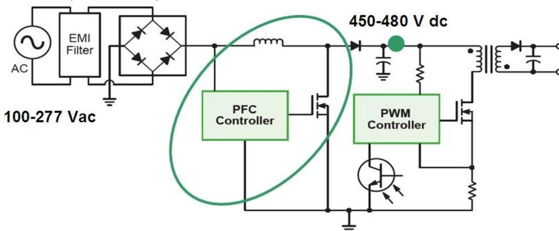
图 6: 有源 PFC 的应用电路示意图。
