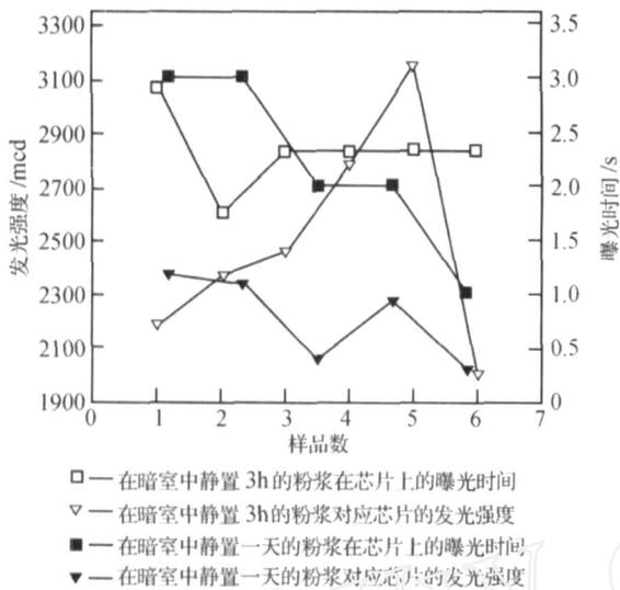
图 4 同一粉浆不同静置时间得到的 LEDs 的发光强度
