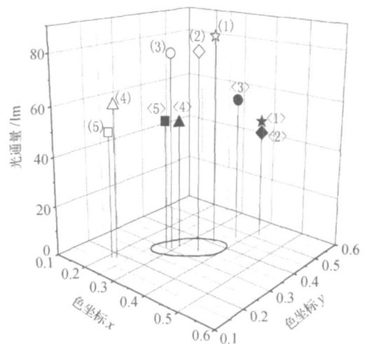
图 6 加硅胶层前后 LEDs 光通量的变化 1~5 是未加硅胶层时 LED 的色坐标和光通量; (1)~(5) 是加硅胶层后 LED 的色坐标和光通量.
