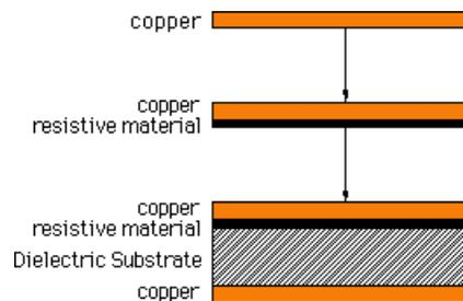
根据刻蚀的尺寸不同可以实现不同的阻值。这种材料的电阻单位一般是 OHM PER SQUARE，即每单位面积的电阻。比如 100 OHM PER SQUARE，即意味着如果把材料刻蚀成 1mm 宽×1mm 长的正方形会得到 100 欧姆的电阻，如果是 1mm 宽×0.5mm 长的长方形则会得到 50 欧姆的电阻。下图是实现 2.4k 欧姆电阻的一个方法。
