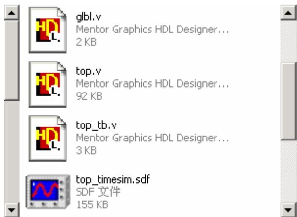
post-map 仿真跟上述类似，post-translate 没有“\*.sdf”文件，功能仿真除了没有“\*.sdf”文件外还没有“g1b1.v”文件；
