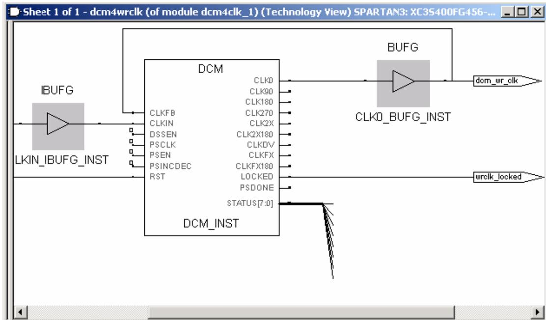
不管你相信与否！Synplify.Pro 已经生成了你所希望的东西。（拥有专用 Clock-Input-Buffer, IBUF 连接的 DCM 结构, 并且有一个从 Global-Clock-Buffer, BUFG 的反馈结构“CLKFB”）
