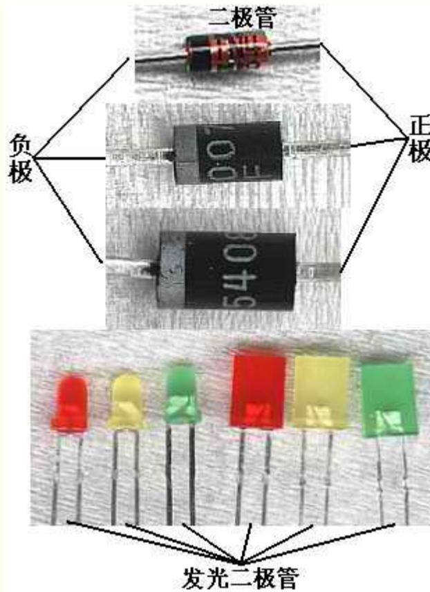
从二极管的作用上分类可分为：整流二极管、降压二极管、稳压二极管、开关二极管、检波二极管、变容二极管；从制作材料上可分为硅二极管和锗二极管。无论是什么二极管，都有一个正向导通电压，低于这个电压时二极管就不能导通，硅管的正向导通电压在  $0.6V \sim 0.7V$ 、锗管在  $0.2V \sim 0.3V$ ，其中  $0.7V$  和  $0.3V$  是二极管的最大正向导通电压——即到此电压时无论电压再怎么升高（不能高于二极管的额定耐压值），加在二极管上的电压也不会再升高了。
