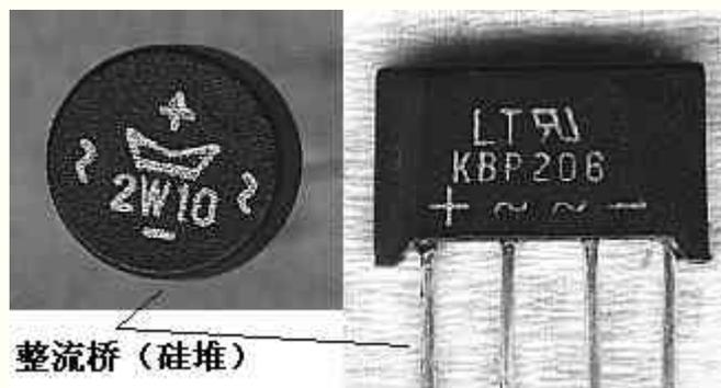
下面笔者再说一下不同的二极管的不同作用：彩显中有很多整流二极管，有四个整流二极管的作用是将  $220V$  的交流电变换成  $300V$  直流电，也就是最著名的整流桥电路，当然，有相当一部分彩显已将这四个二极管整合为一个硅
