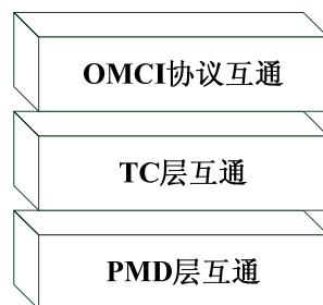
图 9 GPON 系统互通性参考模型
