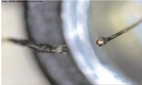
图 1：LED 焊接线烧断损坏。
