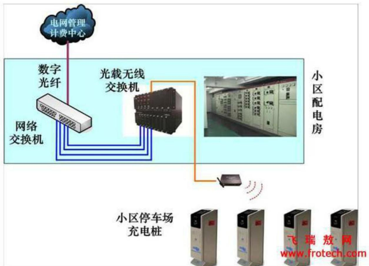
(1) 局部区域的充电桩通过 400MHz 频率的低速无线数据传输方式，将充电桩的数据汇聚到中间节点（简称汇聚节点，汇聚节点为其中的一个充电桩），汇聚节点内置 WiFi 中间件，完成汇聚数据到 WiFi 无线网络数据的转换。
