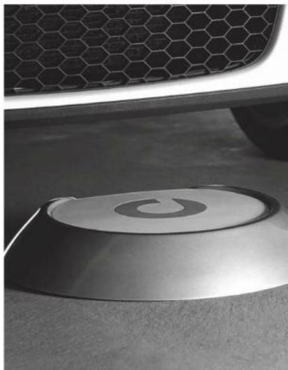
此，磁耦合谐振式无线电力传输技术进入了电动车相关研究人员的视野。利用无线充电，只需要改装现有的停车场，就能够给电动车充电，不会占用过多的城市空间。由于不需要快速充电，也不会给电网施加过大的压力。这项技术的应用，突破了电动车推广中的电池难题。目前，东南大学的研究人员已经将无线传输的距离增加到50厘米左右。这是国内唯一实现0.5米以上千瓦级无线功率传输的研究成果。
