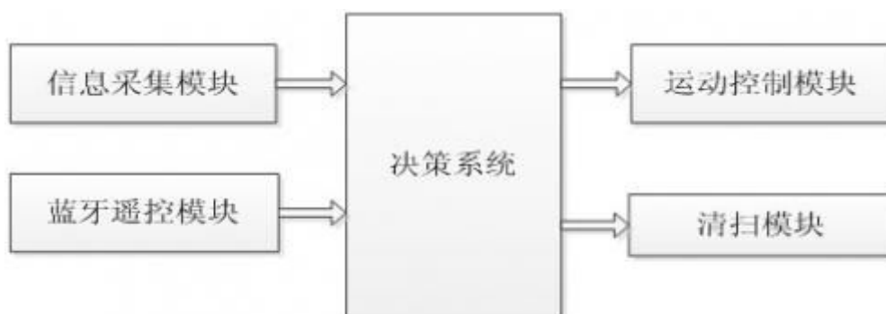
图2-1清洁机器人系统典型组成示意图
