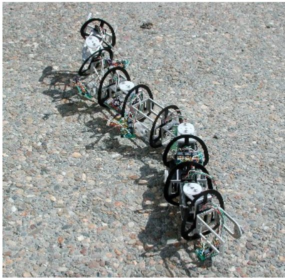
正在研制的用于火星探测的蛇形机器人第三代模型 NASA/乔纳斯·迪道供图
