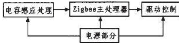
图 1 开关总体结构图
