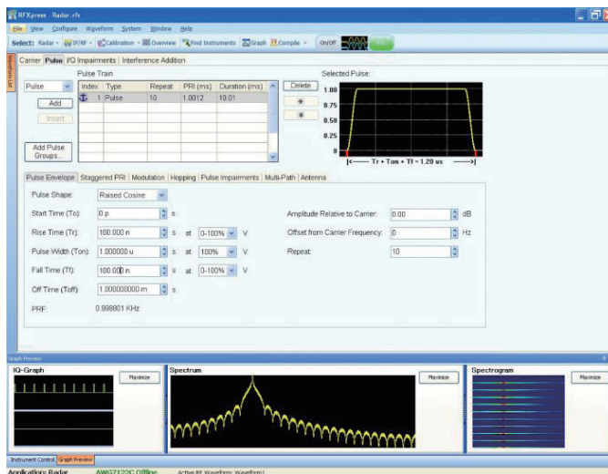
使用 AWG70000A 和 RFXpress 创建的 AWG 雷达脉冲。
