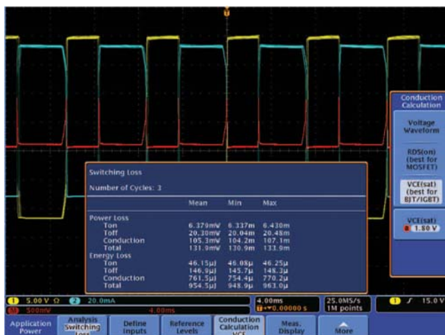
图 13. DPOxPWR 测量 IGBT 上的开关损耗。
