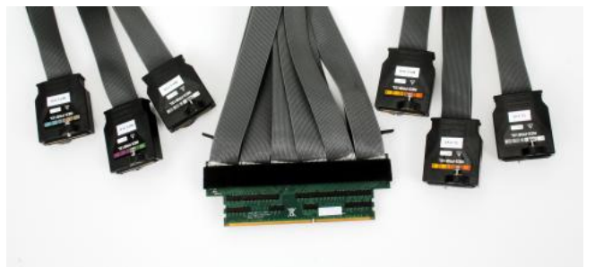
TLA 逻辑分析仪和探头, 支持多通道信号捕获
