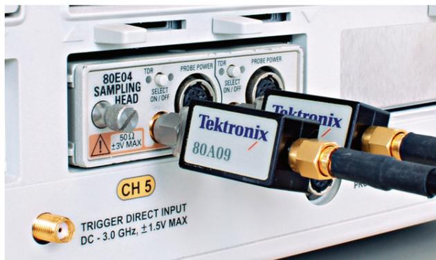
产品化的 80A09 有更小的物理尺寸 ( 如上图所示，大小类似一个火柴盒)，80A09 插入 80E04 TDR 模块输入和被测器件之间的路径中，带有双电通道的采样模块，如带有 TDR 的 80E04 双通道 20 GHz 电接口采样模块，则要求两个 80A09
