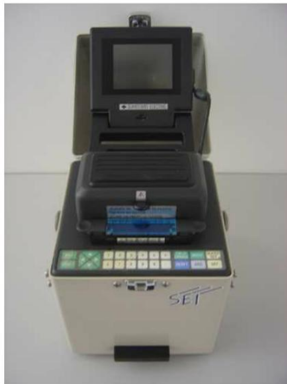
图 1 住友公司 ETK9724098 Type-36 型光纤熔接机
