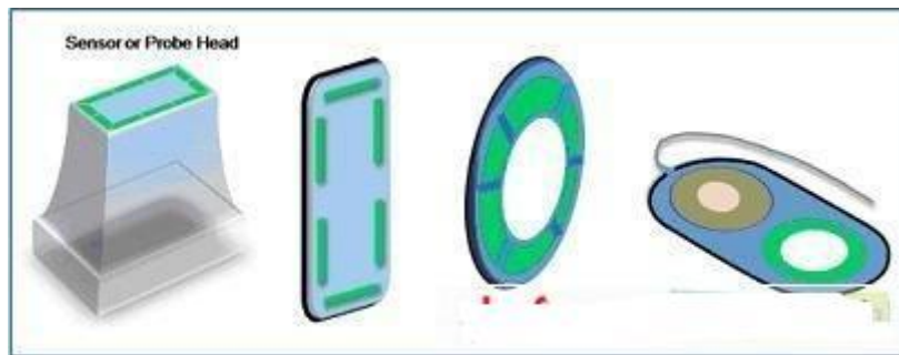
图 1. 使用容性传感器电极的器件
