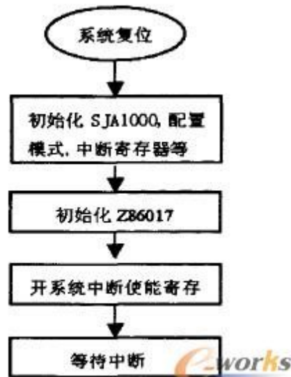
图 6 PCCard 侧微控制器对 CIS 的初始化程序流程图
