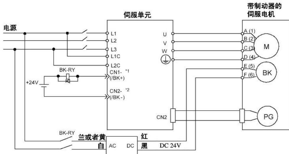
BK-RY: 制动器控制继电器 制动器电源配备有200V、100V用的产品。
