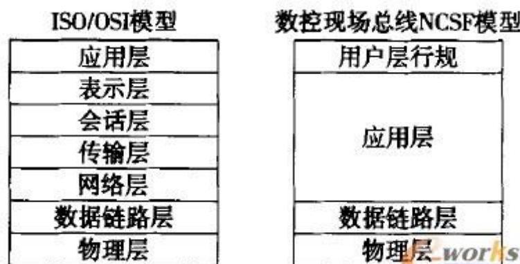
图 2 数控现场总线 NCSF 网络模型
