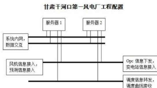
该系统配置为双机双网结构，每个服务器配置 4 个网口，其中网卡一、二配置为系统内网，负责两台服务器数据的交互和同步，网卡三负责厂内风机控制系统 OPC、变电站远动系统，风力发电预测系统的接入，
