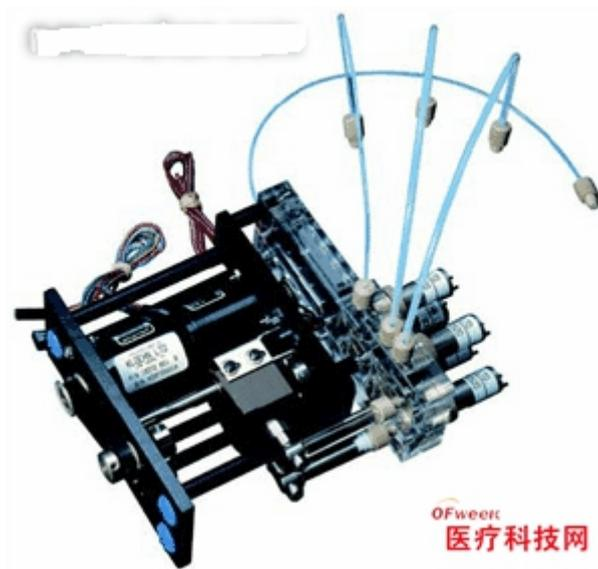
上图是一种应用于血液分析的典型高度集成，其所完成的功能包括：试剂、样品的吸样、分配；试剂、样品的混合以及反应液的光学分析、判读。
