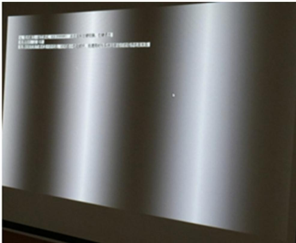
而在通过 M5-Bypass 的显示效果如下所示（几张示例图片），几种颜色的灰阶都出现亮线。
