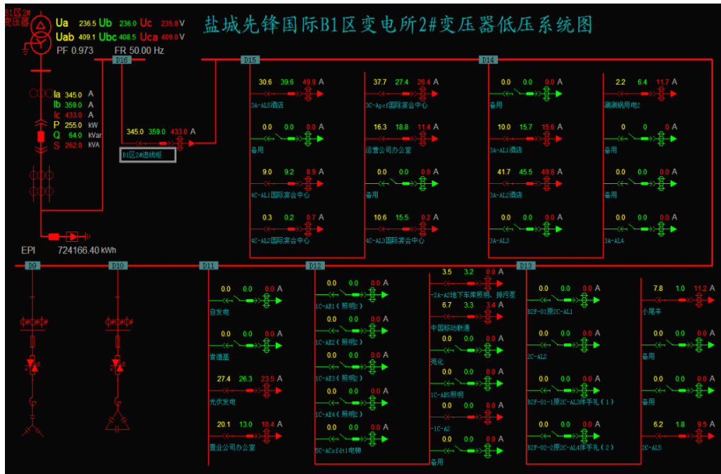
图 2 0.4KV 低压一次系统图
